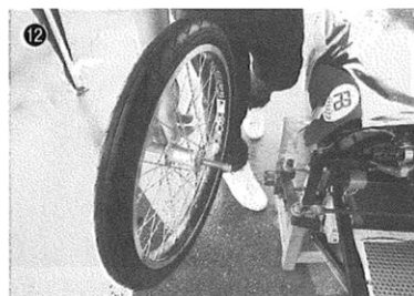
⑫前輪は脱着式の凝った造りで、不意のバンクでも即対応できる。
